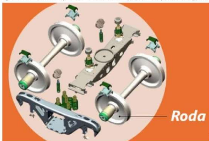
Figura 01: Localização da roda no truque de tração de vagões e locomotivas: 2024
